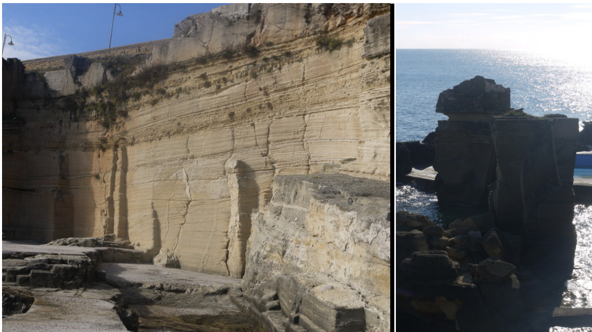
Figura 5: Foto indicanti i livelli marnosi della Calcareniti di Gravina oggetto di erosione selettiva e instabilità dei blocchi rocciosi sovrastanti
