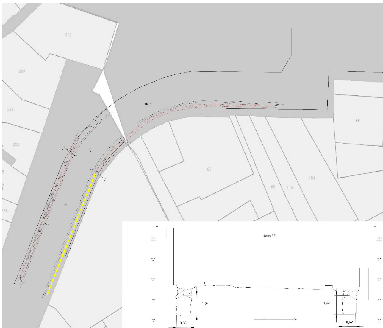
Figura 9. Percorsi condotte idriche.
