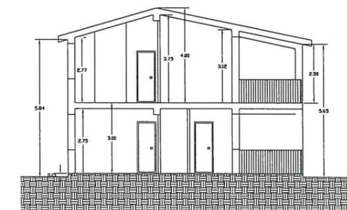
Sezione A-A alloggio diversamente abili
