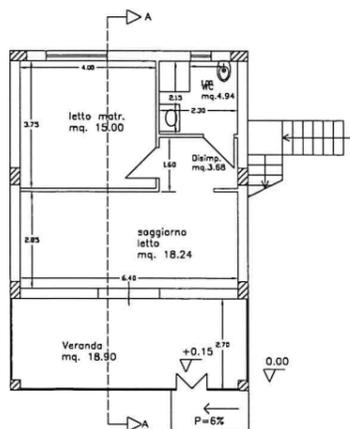
Pianta piano terra alloggio diversamente abili quotato
