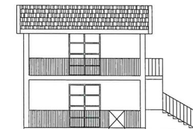
Prospetto anteriore alloggio diversamente abili
